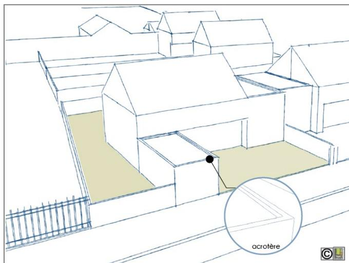
**Acrotère** : Saillie verticale d'une façade\*, au-dessus du niveau d'une toiture terrasse ou d'une toiture à faible pente pour en masquer la couverture. L'acrotère est souvent constitué d'un muret situé en bordure des toits terrasses pour permettre le relevé d'étanchéité.
