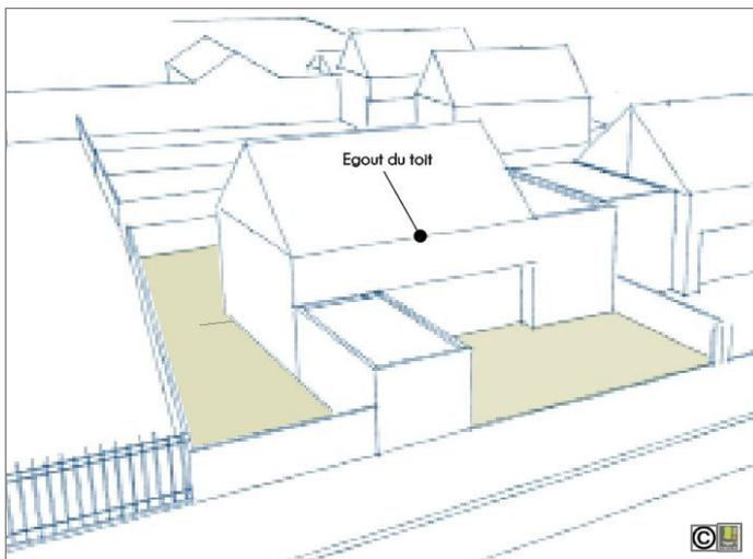
**Egout du toit** : Partie basse d'un pan de couverture vers lequel s'écoulent les eaux pluviales. L'égout du toit correspond, dans la plupart des cas, à la partie haute d'une gouttière ou d'un chéneau.
