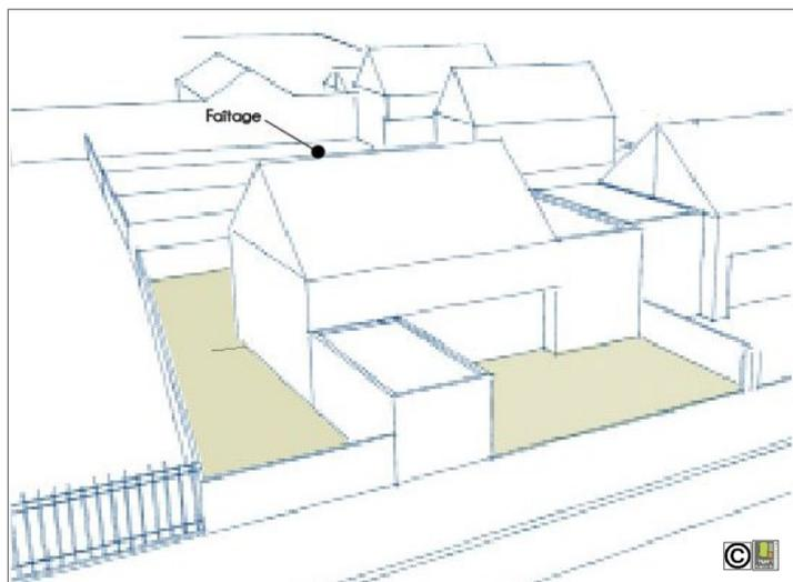
**Faîtage** : Ligne de jonction supérieure de deux pans de toiture inclinés suivant des pentes opposées.
