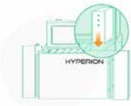
1, Les serveurs sont immergés dans des cuves en inox contenant un fluide biodégradable non conducteur en électricité
